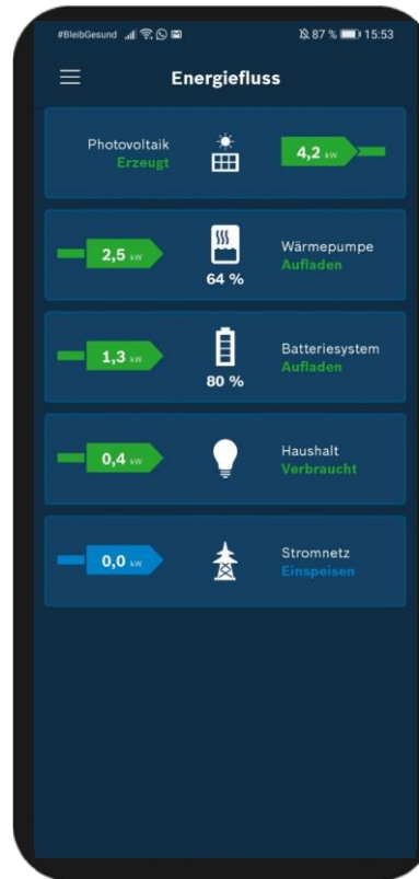
Aktuelle Werte: Energiefluss
